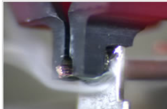
导线和圆孔端子焊锡
