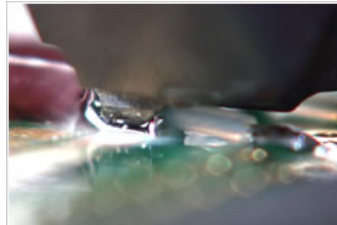
同轴线外部导体焊锡
