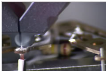
金属板和元件引脚焊锡
